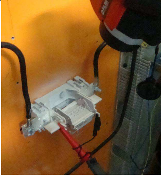
Abbildung 7: Versuchsaufbau der Wärmebildkameramessungen
